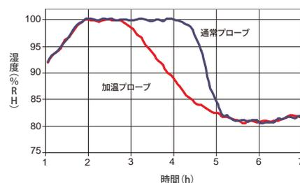
100%の相対湿度が続いた後でも、加温プローブなら正確な湿度計測が可能ですが、非加温プローブでは結露からの回復に時間がかかります。
