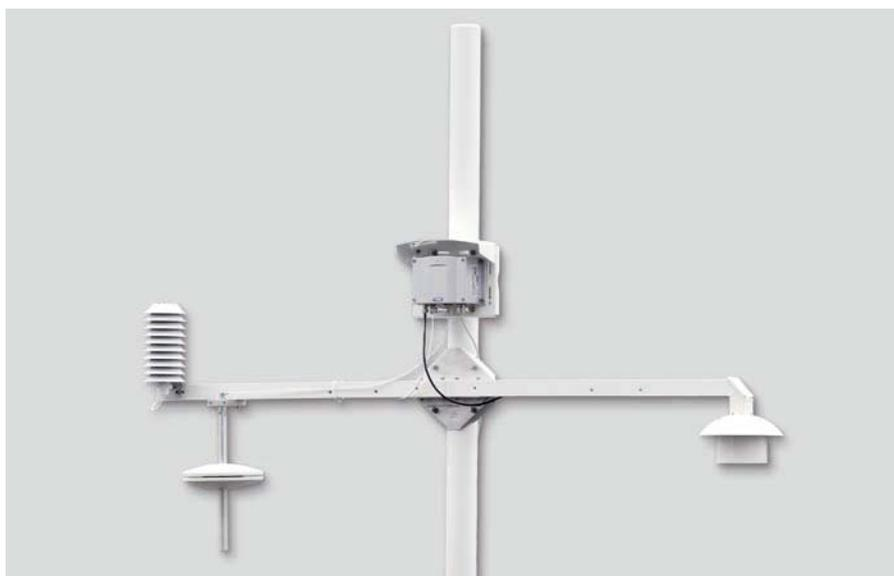
HMT337およびPTU307は加温プローブ技術を採用しています。HMT330MIKキットに取り付けて使用すれば、高湿度の気象条件下で信頼性の高い湿度計測が可能です。
