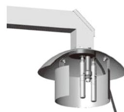
校正の際は、HMT337またはPTU307プローブの横に、ハンディタイプ基準プローブHMP77を簡単に取り付けられます。
